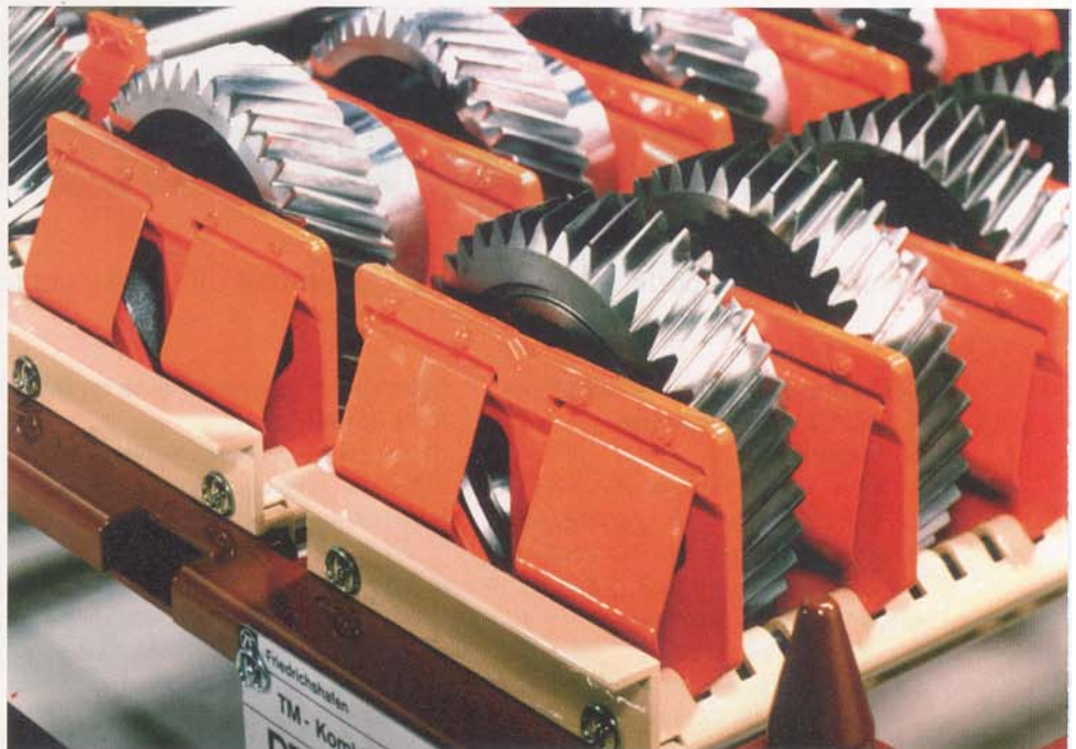
Federanschlüsse halten das Werkstück genau in der gewünschten Lage.
