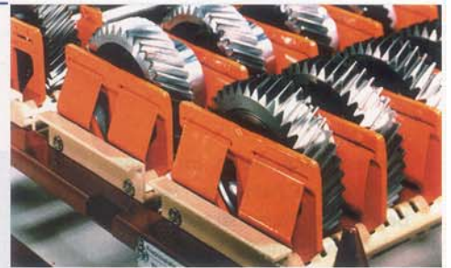
Werkstückträger begleiten die Werkstücke wie Zahnräder, Kurbelwellen oder Getriebegehäuse durch die gesamte Fertigung. Sie nehmen Rohteile auf und stellen sie zur Bearbeitung bereit, transportieren sie schonend und sicher durch Wasch- und Konservierungsanlagen und je nach Anwendung bis in die Kommissionierung (Bilder: 3F)
